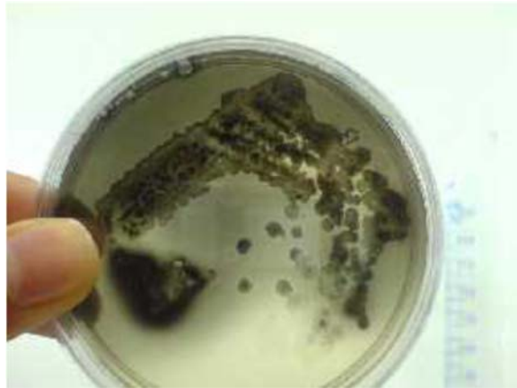
شکل ۴-۲: تشکیل کلونی‌های سیاه رنگ توسط باکتری‌های احیا کننده سولفات بر محیط کشت API
