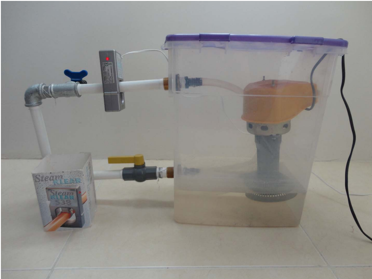
شکل ۳-۳ نمایی از ساخت سیستم گردش آب به همراه دستگاه مولد امواج رادیویی
