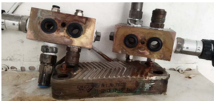
شکل ۹-۲ تصویر ورودی های مبدل حرارتی صفحه‌ای پس از اتمام آزمون در حالیکه از Electronic water conditioner استفاده شده بود
