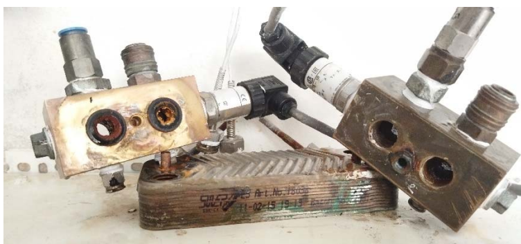
شکل ۱۰-۲ تصویر ورودی های مبدل حرارتی صفحه‌ای پس از اتمام آزمون در حالیکه از Electronic water conditioner استفاده نشده بود
